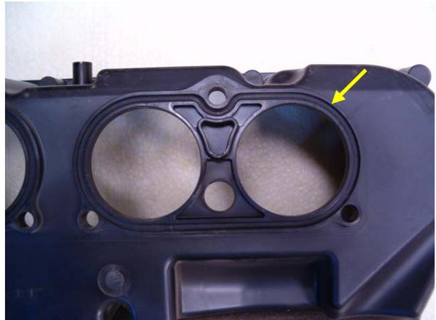
Nota: en la parte inferior de la caja del filtro y por parejas de orificios de admisión existe una junta de goma (última fotografía, flecha amarilla) que no debemos perder puesto que tras el montaje tendríamos una entrada de aire indeseada y sin pasar por el filtro en la admisión.
