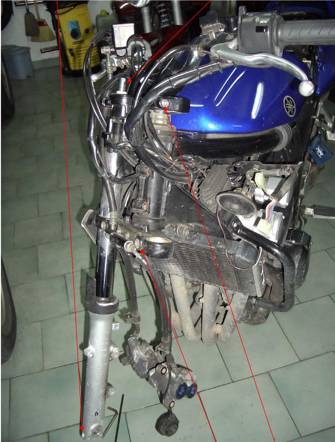
Luego hay que aflojar 2 tornillos por barra. El de la tija inferior y de la superior, ambos de cabeza allen.
