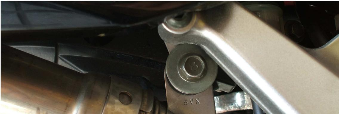
Ponemos juntas de escape nuevas y colocamos el tubo en su sitio. Colocamos algunas tuercas en la culata sin apretar para que no se mueva de su sitio, colocamos el tornillo de fijación inferior. Cuando terminemos de montar el escape lo apretaremos a 20 Nm.
