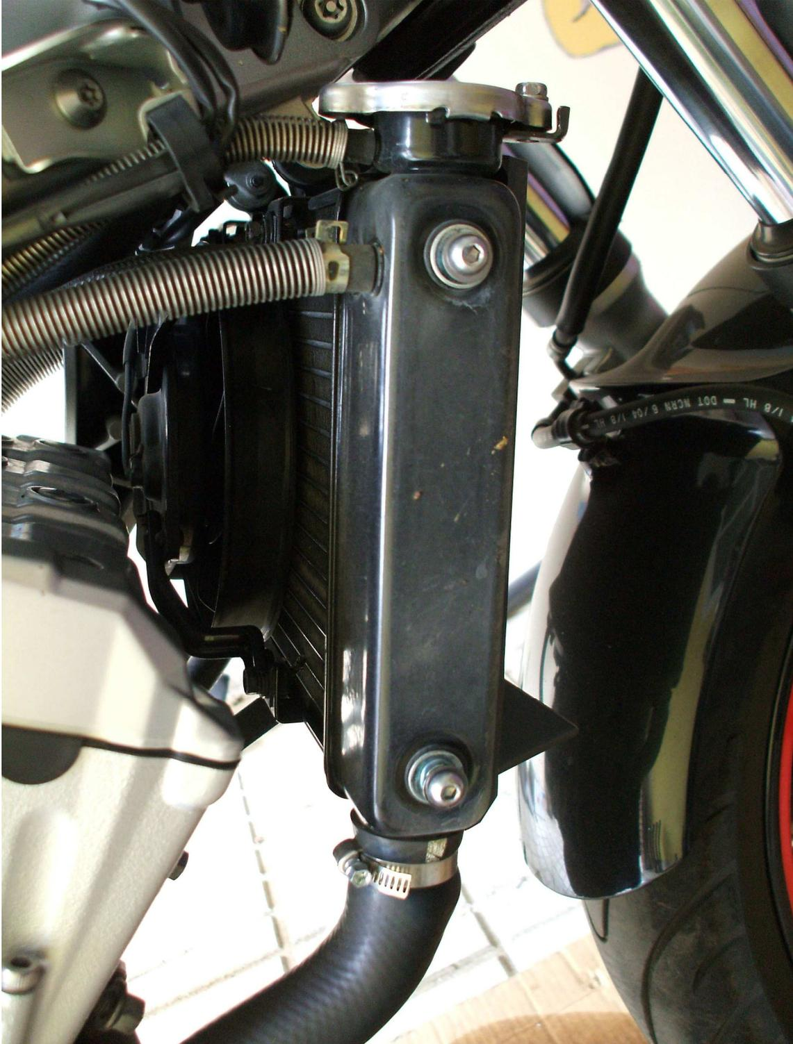
Ahora nos vamos al otro lateral y retiramos de arriba abajo, el manguito de entrada al radiador y la manguera de salida del radiador de aceite:
