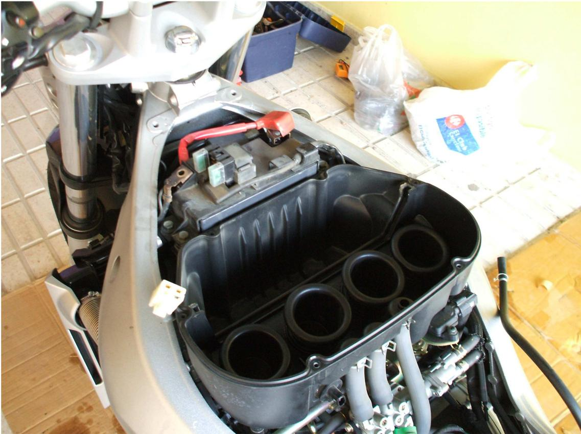
Para retirar la caja del filtro de aire debemos aflojar las cuatro abrazaderas que lo unen al cuerpo de la mariposa:
