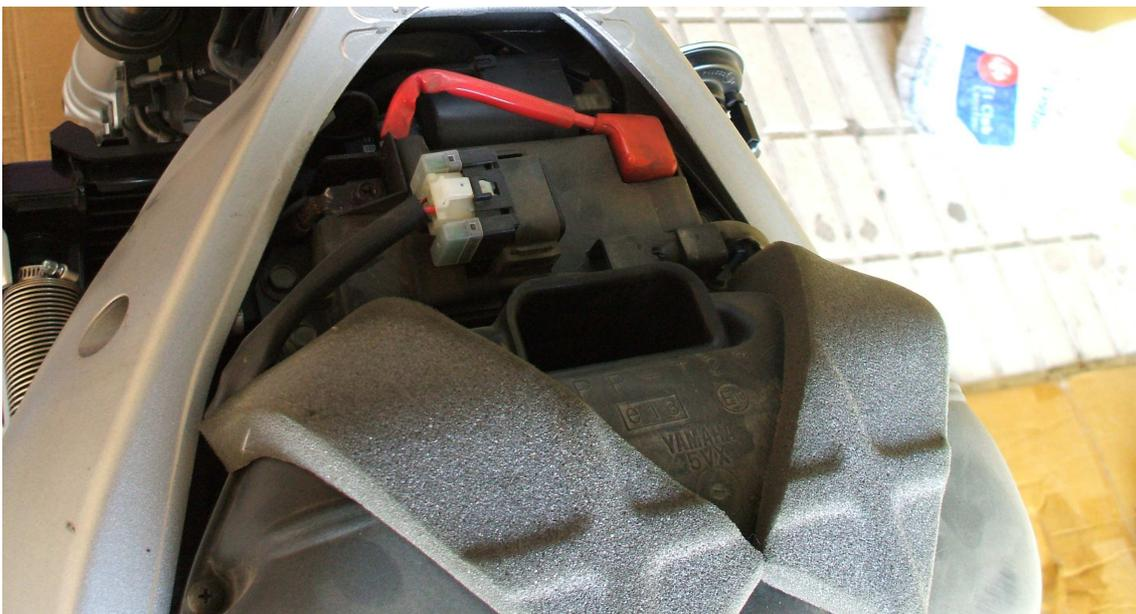
Atornillamos el eje del depósito de combustible y conectamos los tubos de respiradero, el tubo de combustible y los conectores de la bomba
