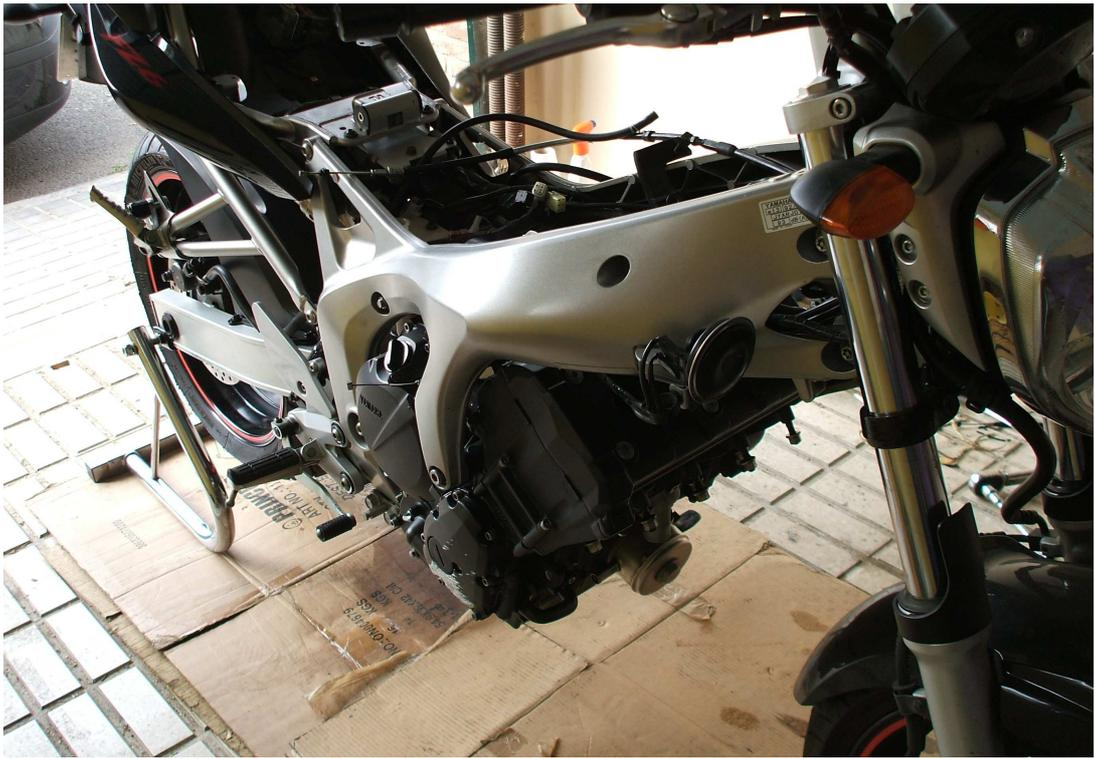
Una vez colocados los dos pernos y los tres tornillos procedemos a apretarlos con la dinamométrica a un par de 55 Nm.
