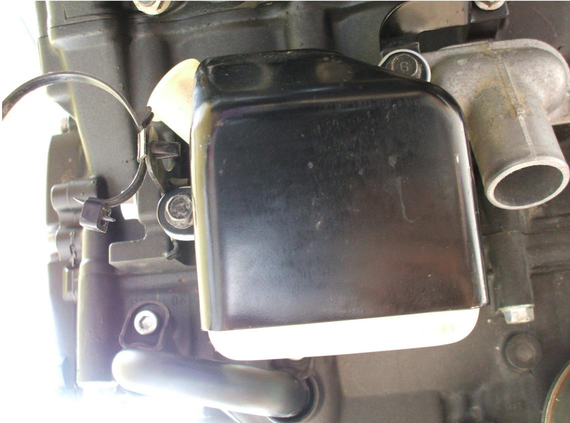
Conectamos los tubos que van desde la bomba de agua hasta el motor (la toma que se ve en la foto anterior, a la derecha del depósito de agua) y al refrigerador de aceite, no olvidándonos de apretar y colocar bien todas las bridas y abrazaderas.
