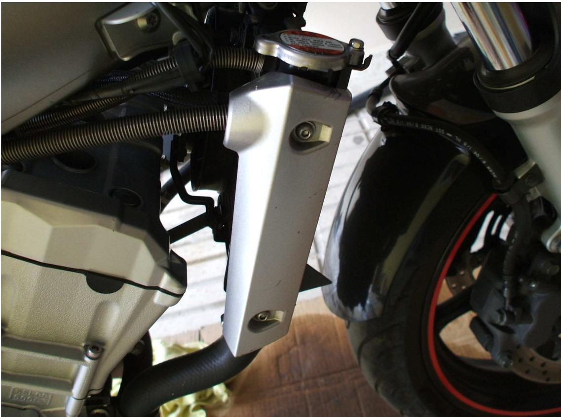
Vamos a vaciar el líquido refrigerante a través del tornillo de drenaje de la bomba de agua. Hay que tener cuidado porque sale con bastante fuerza y nos pondrá perdidos:
