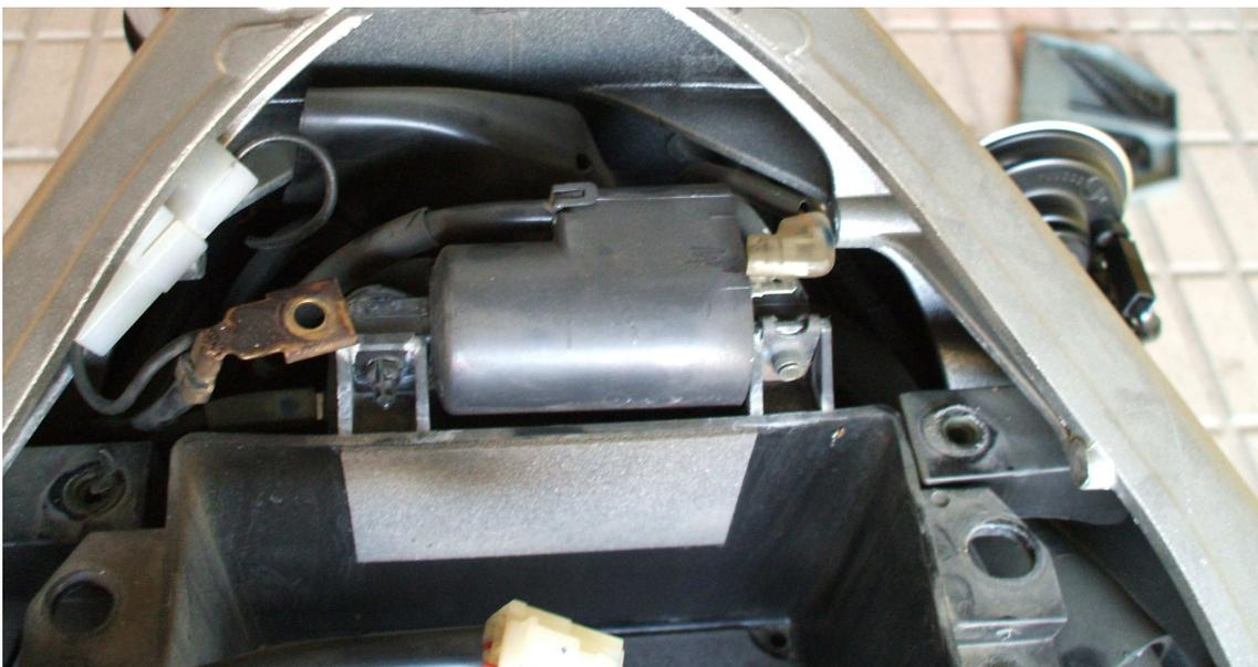
Cada bobina está sujeta a la caja de la batería con un tornillo y una especie de remaches de plástico. Estos remaches los encontraremos en más lugares de la moto. Para retirarlos hay que conseguir que el perno interior salga hacia fuera. Dependiendo
