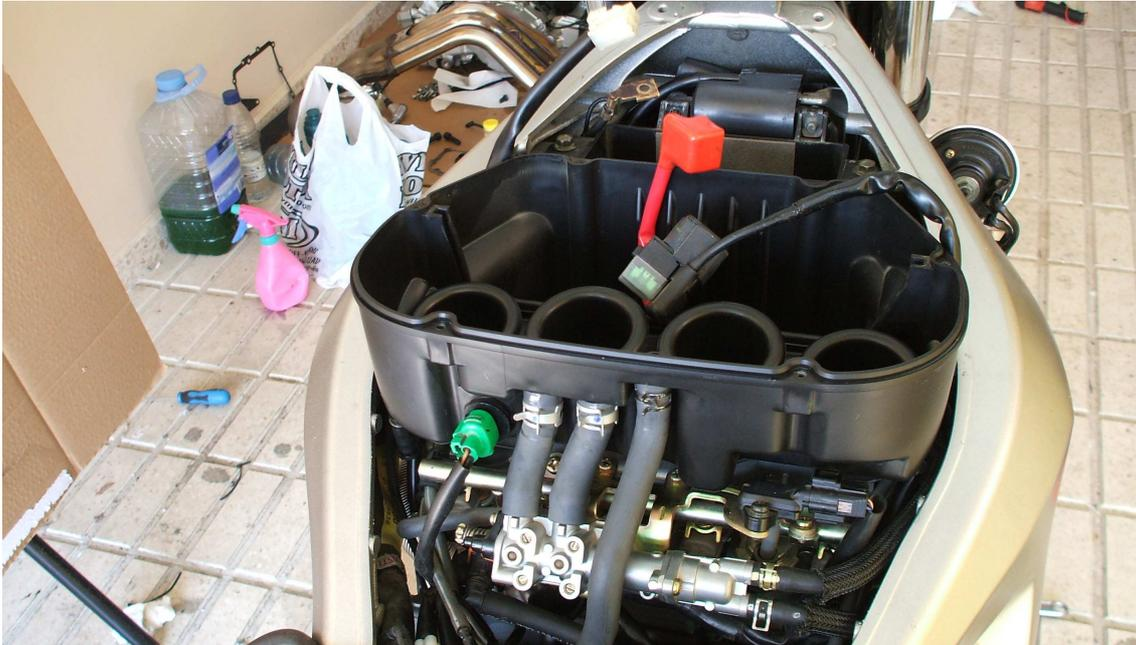
Colocamos el filtro de aire y atornillamos la tapa. Metemos la batería en su sitio y la tapa, conectando los bornes positivo y negativo y colocando el conector del relé:
