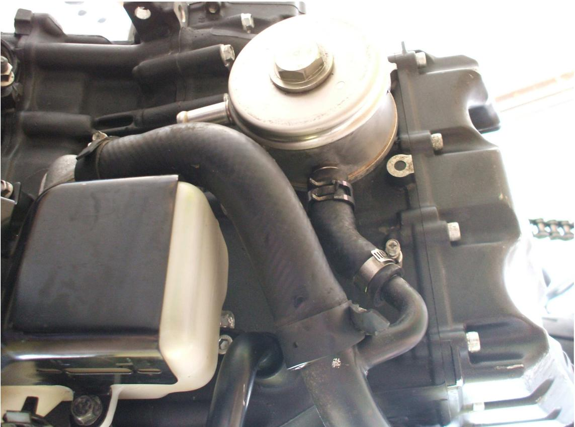
Colocamos el tapón del depósito, pasando el tubo de drenaje por dentro de la tubería metálica en forma de U que hay debajo del depósito. Así no se queda suelto. El tubo principal debe ir rodeando el motor, como se muestra en la foto:
