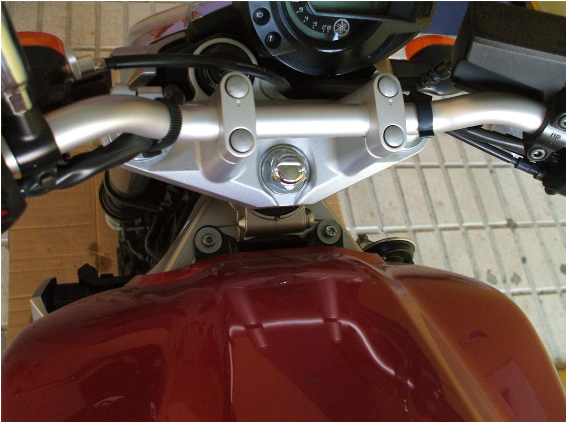
Levantamos el depósito y lo fijamos a algún sitio. (podemos usar una cuerda atada a la parte trasera de la moto) Marcamos la posición de los tubos y cables para no equivocarnos en el montaje.
