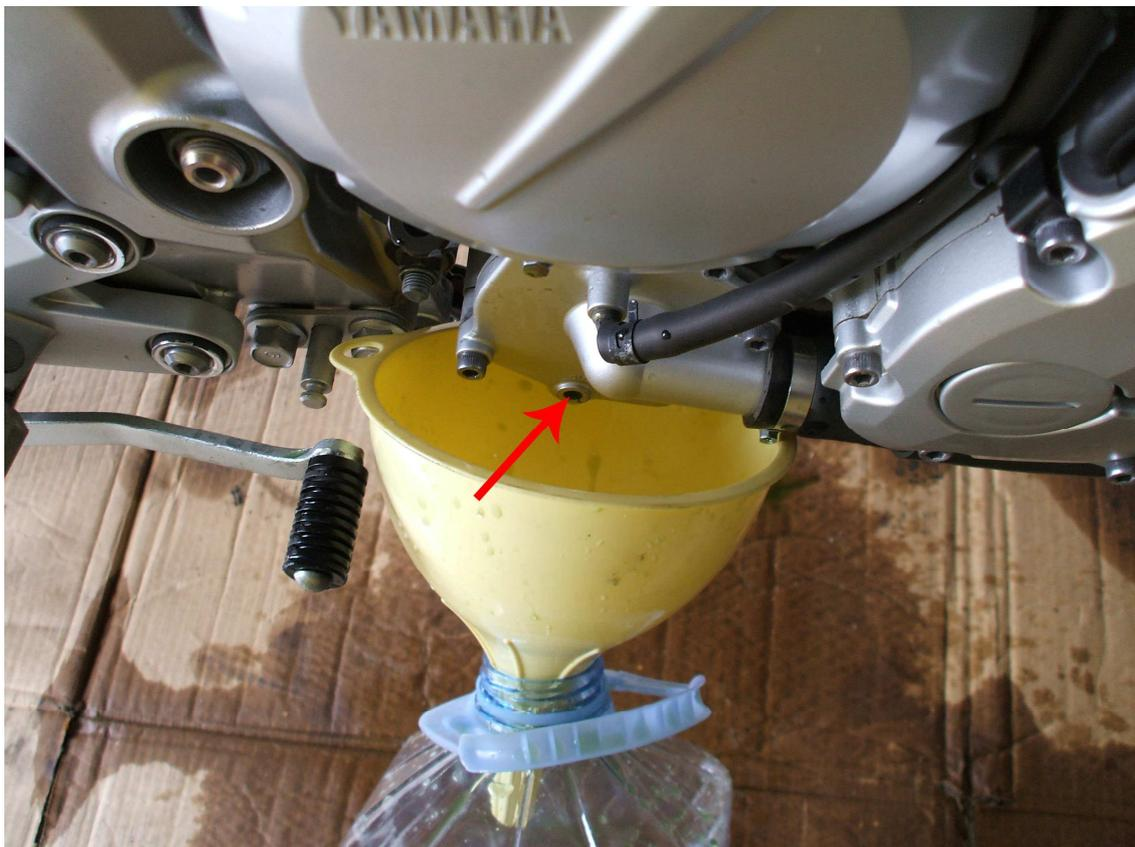
Vamos a retirar todos los tubos que van al radiador. Empezaremos por el lateral derecho, retirando de arriba abajo el tubo del depósito de líquido refrigerante, el de ventilación de la bomba de agua, el del cuerpo de mariposa y el manguito de salida del radiador. El truco para sacar los manguitos es retirar la abrazadera que los aprieta y forzarlos para que giren un poco. De esta manera se despegan y salen muy fácilmente.
