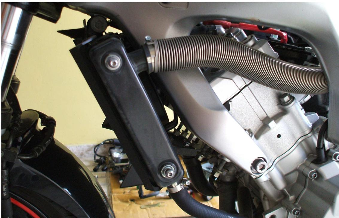
Desconectamos el cable del ventilador:
