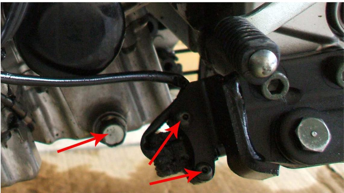
En este punto el motor está preparado para poder soltarlo del chasis. Es recomendable inspeccionarlo muy bien para verificar que todos los tubos y cables están desconectados y que no hay nada que impida su extracción (exceptuando los tornillos que lo fijan al chasis).
