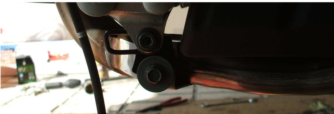
Montamos el tronillo de fijación del tramo del catalizador que quitamos antes con un apriete de 16 Nm y apretamos la brida de sujeción de los colectores al catalizador con 20 Nm.
