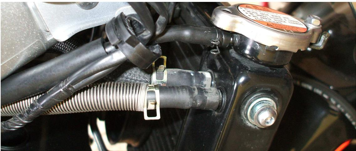
Introducimos el cable del ventilador a través del protector térmico de goma y lo conectamos.
