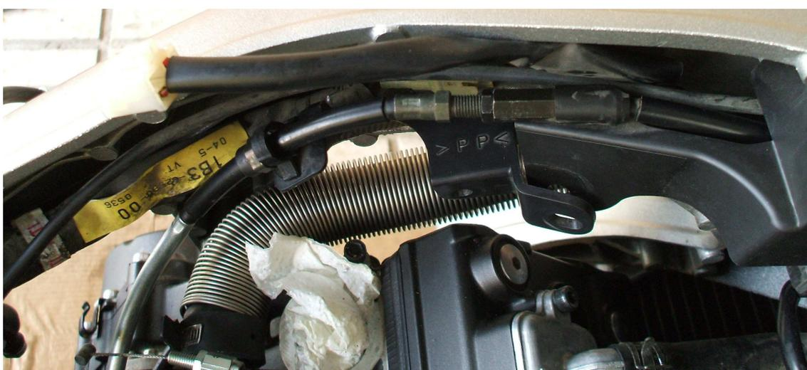
Colocamos el cable del motor de arranque
