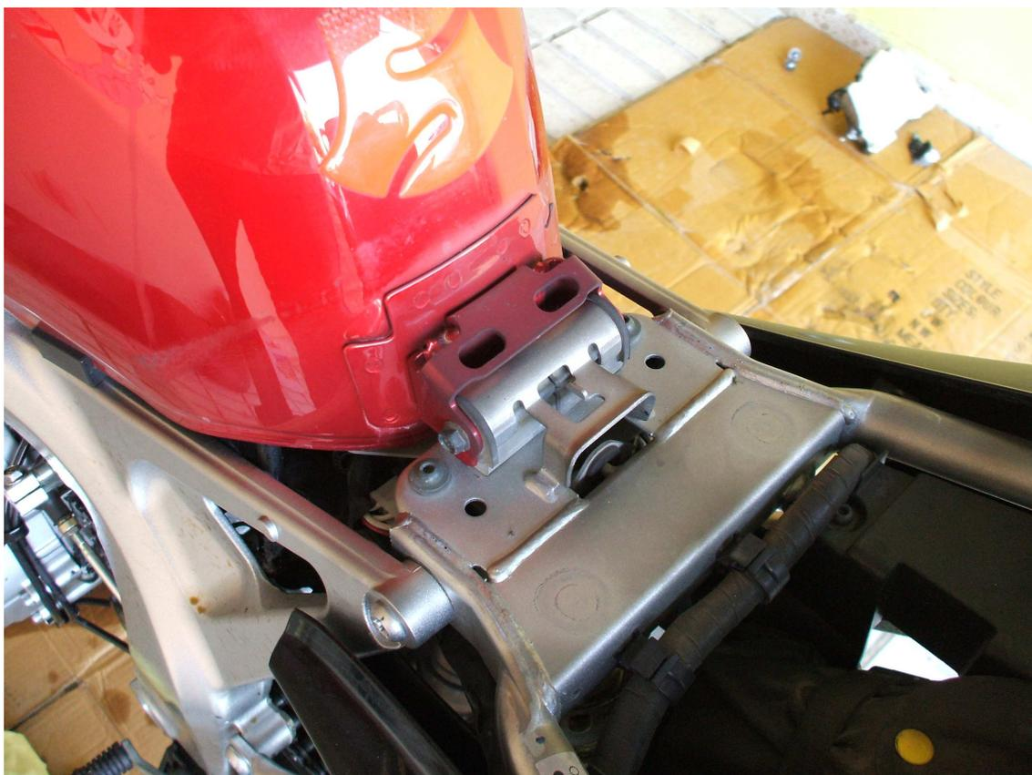
Ya podemos retirar el depósito. Hay que tener cuidado con el tubo de plástico de la bomba ya que es fácil romperlo. Apoyaremos el depósito sobre dos calzos de manera que el tubo no toque el suelo.
