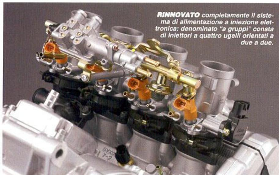
**RINNOVATO** completamente il sistema di alimentazione a iniezione elettronica: denominato "a gruppi" consta di iniettori a quattro ugelli orientati a due a due.
