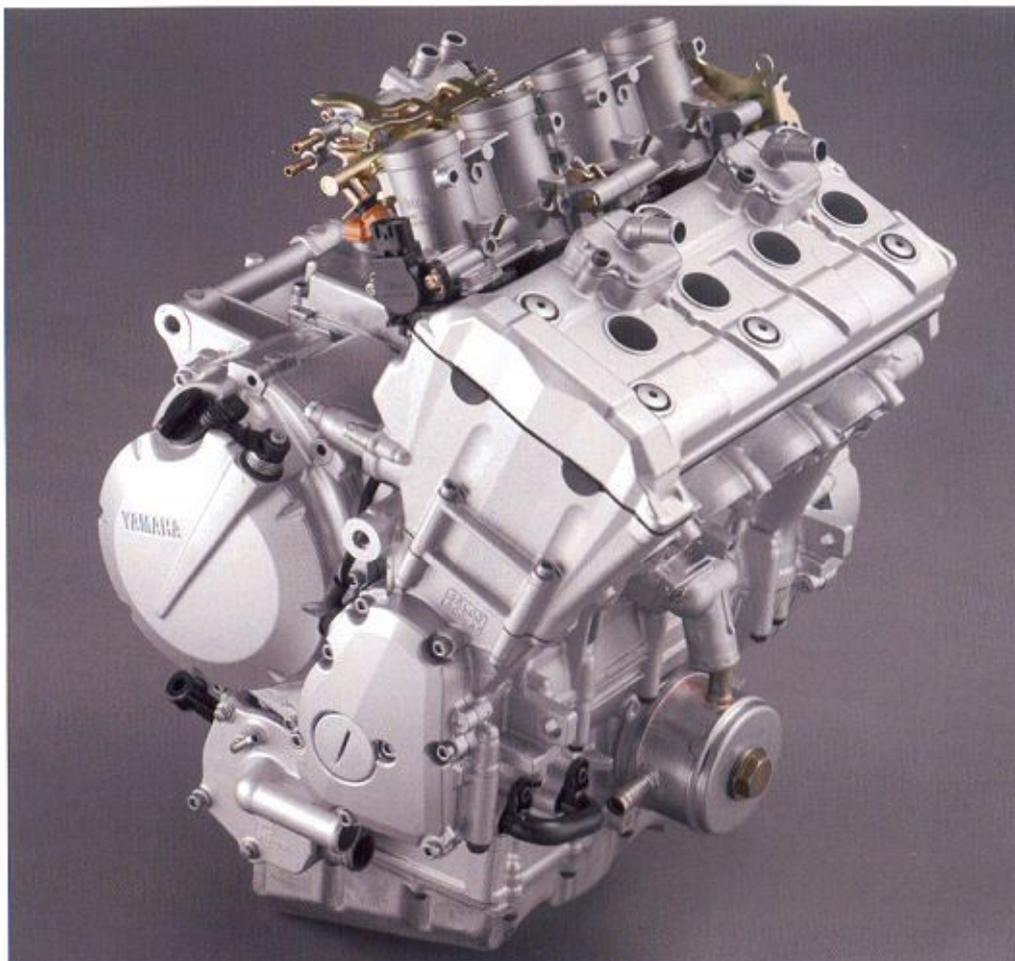
**IL QUATTRO** cilindri che spinge la Yamaha FZ6 è la stessa unità installata sulla velocissima R6, ovviamente modificata per il differente utilizzo: gli interventi maggiori sono stati sulla distribuzione e sul sistema di alimentazione. Qui sotto si può osservare la moto spogliata delle sovrastrutture: si notino il propulsore (vincolato al telaio in cinque punti) e l'andamento dell'impianto di scarico, con i due silenziatori alloggiati all'interno del codone.
