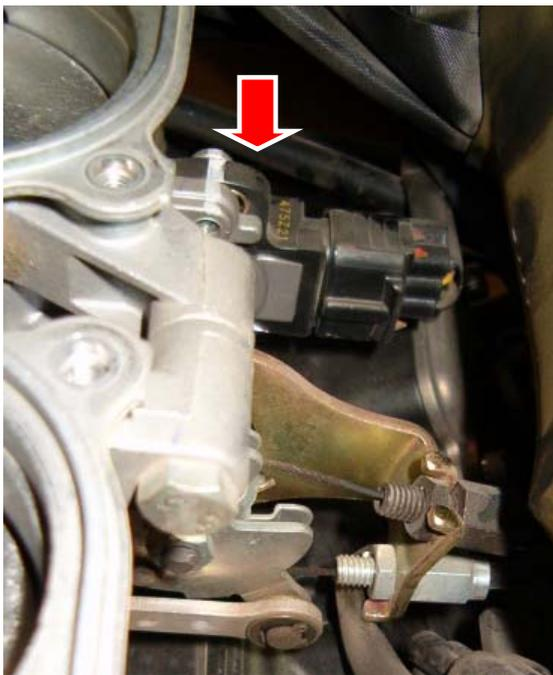
extraed el sensor de posición de las mariposas. Conectar el polímetro en su escala de medición de resistencias ( $\Omega \times 1k$ ) al sensor de posición de las mariposas:
