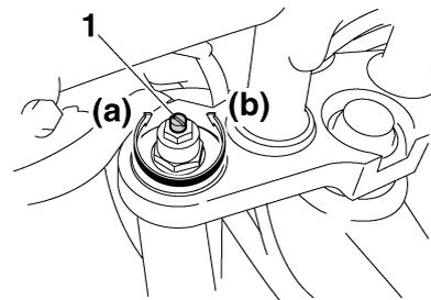
1. Tornillo de ajuste del hidráulico de compresión
