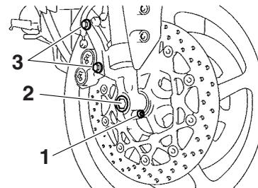
1. Remache de plástico desmontable del eje de la rueda delantera
