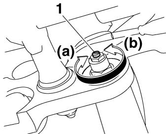
1. Tornillo de ajuste del hidráulico de extensión
