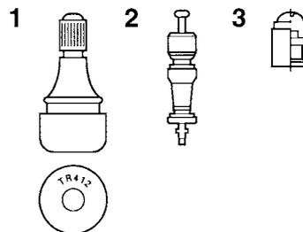
1. Válvula de aire del neumático
