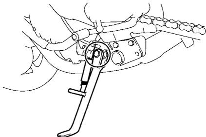
Antes de cada utilización debe comprobar el funcionamiento del caballete lateral y engrasar el pivote y las superficies de contacto metal-metal si es necesario.
