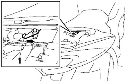
1. Palanca de bloqueo del asiento del conductor
