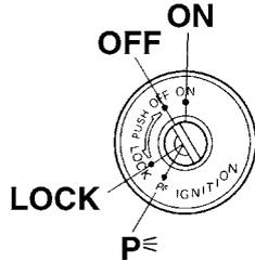
El interruptor principal/bloqueo de la dirección controla los sistemas de encendido y luces y se utiliza para bloquear la dirección. A continuación se describen las diferentes posiciones.
