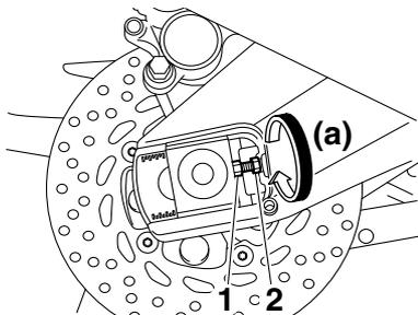
1. Perno de ajuste del juego de la cadena de transmisión
