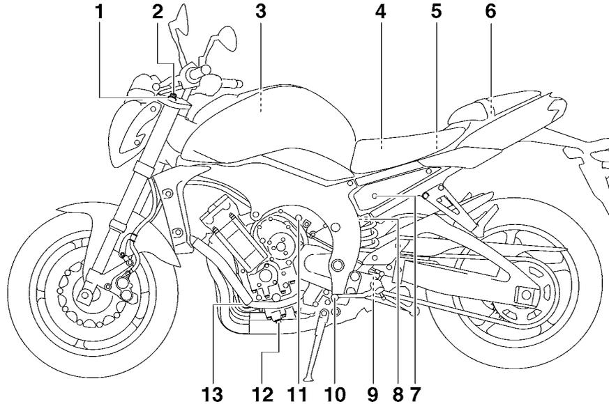
1. Perno de ajuste de la precarga del muelle de la horquilla delantera (página 3-20)
