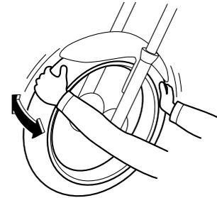
Debe comprobar los cojinetes de las ruedas delantera y trasera según los intervalos que se especifican en el cuadro de mantenimiento periódico y engrase. Si el cubo de la rueda se mueve o si no gira con suavidad, solicite a un concesionario Yamaha que revise los cojinetes de la rueda.
