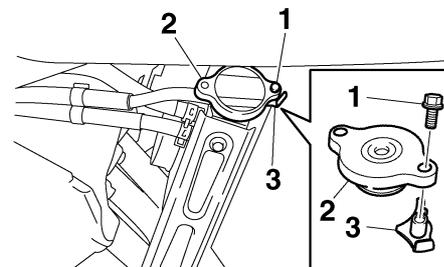
1. Perno de sujeción del tapón del radiador
