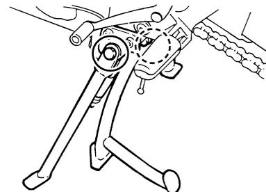
Antes de cada utilización debe comprobar el funcionamiento de los caballetes central y lateral y engrasar los pivotes y las superficies de contacto metal-metal según sea necesario.
