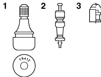
1. Válvula de aire del neumático
