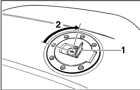
1. Cubierta de la cerradura del depósito de gasolina
