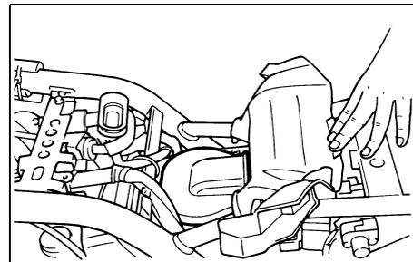
4. Extraiga la cubierta de goma de sus soportes empujándola hacia abajo. Seguidamente tire de ella hacia arriba y hacia atrás como se muestra, separándola de la caja del filtro de aire.
