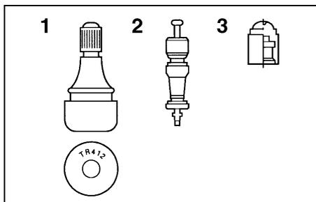
1. Válvula de aire del neumático
