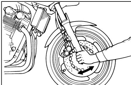
2. Sujete los extremos inferiores de los brazos de la horquilla delantera e intente moverlos hacia adelante y hacia atrás. Si observa cualquier juego libre, solicite a un concesionario Yamaha que revise o repare la dirección.
