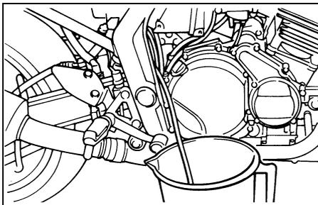
14. Tire del tubo hacia abajo, hacia el exterior, mientras mantiene el extremo arriba; seguidamente incline el tubo hacia abajo en el recipiente para vaciar el depósito de líquido refrigerante.
